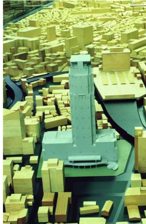
測定孔を設けた模型などにより建物表面の風圧分布を測定
