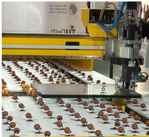
(写真) スペースとガラスの接着部分を専用カッターで自動切断
