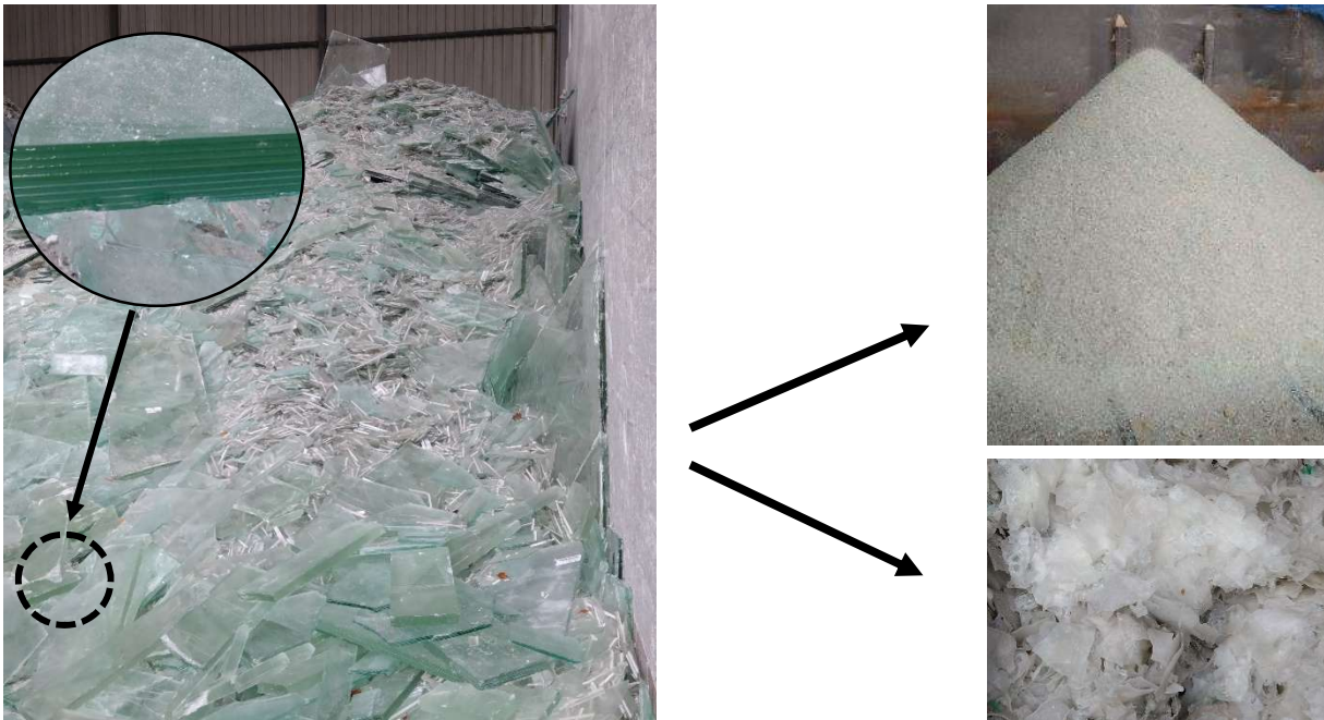
写真：合わせカレット置場と処理後のガラス（左：合わせカレット置場(パイロストップも有り)、 右上：処理後のガラス(中間膜の混入有り)、右下：分離後の中間膜)
