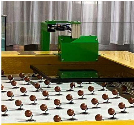
(写真) 複層ガラスを装置にセットし、サイズや厚みを自動認識
