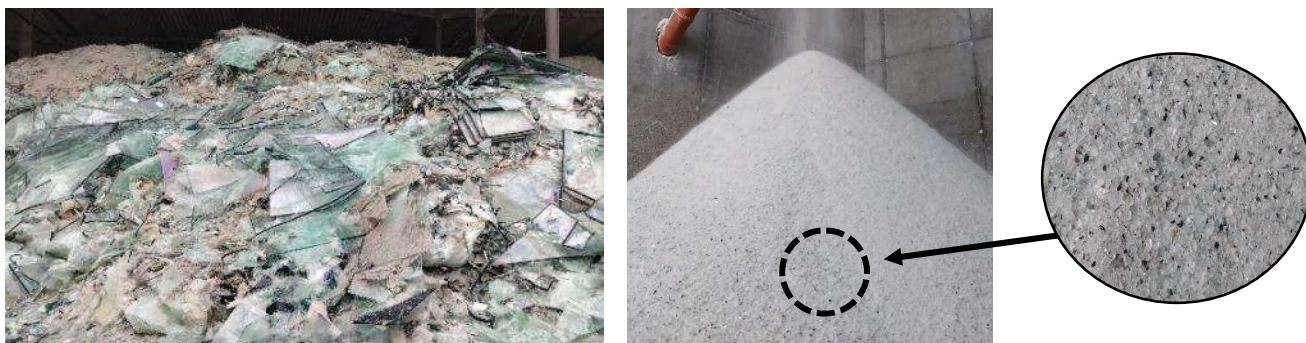
写真：複層カレットと処理後のガラス（左：置場、右：処理後のガラス(異物が混入していることがわかる))
