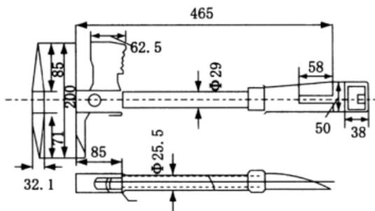
図4 破壊器具
